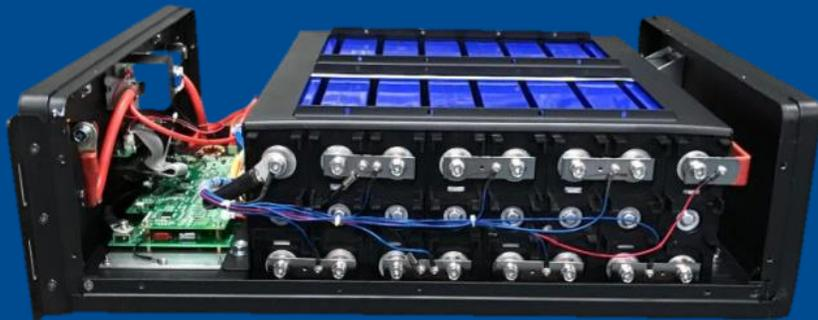
Батарейный модуль 51,2 в (16 ячеек) - основной компонент, содержащий элементы, аккумулирующие энергию.
